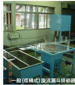
導板末端容易產生紊流使得細顆粒往上揚起降低排砂效率
