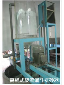
導板末端容易產生紊流使得細顆粒往上揚起降低排砂效率
